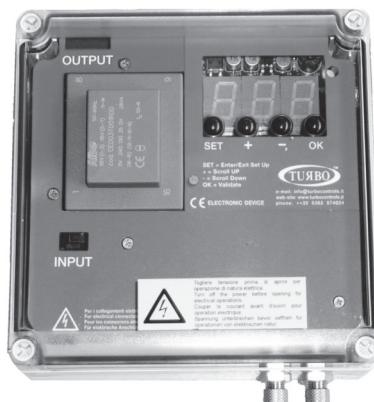
Економайзер призначений для керування (у 4-х режимах) імпульсними клапанами, які керують, у свою чергу, акумульованими аспіраційними блоками. До складу економайзера входить цифрове диференціальне реле тиску, яке дає змогу здійснювати точний аналіз ступеня забруднення фільтр-елемента. Також він має 2 вихідні релейні контакти та 2 цифрові вхідні контакти.
